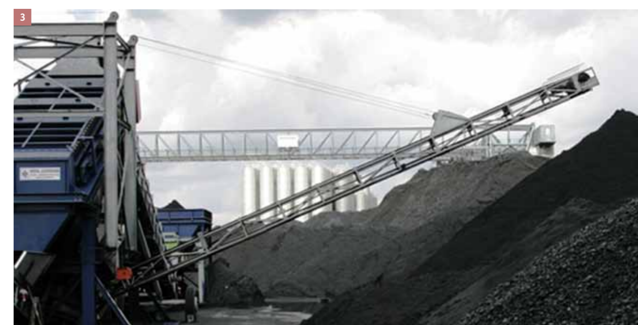
Per Binnenschiff im Hafen Niehl ankommende Kohle wird im Kohlelager gesiebt (1 und 2), dann neu gemischt (3) und geht per Bahn oder LKW zu Kraftwerken und Industrieverbrauchern in der Umgebung.
