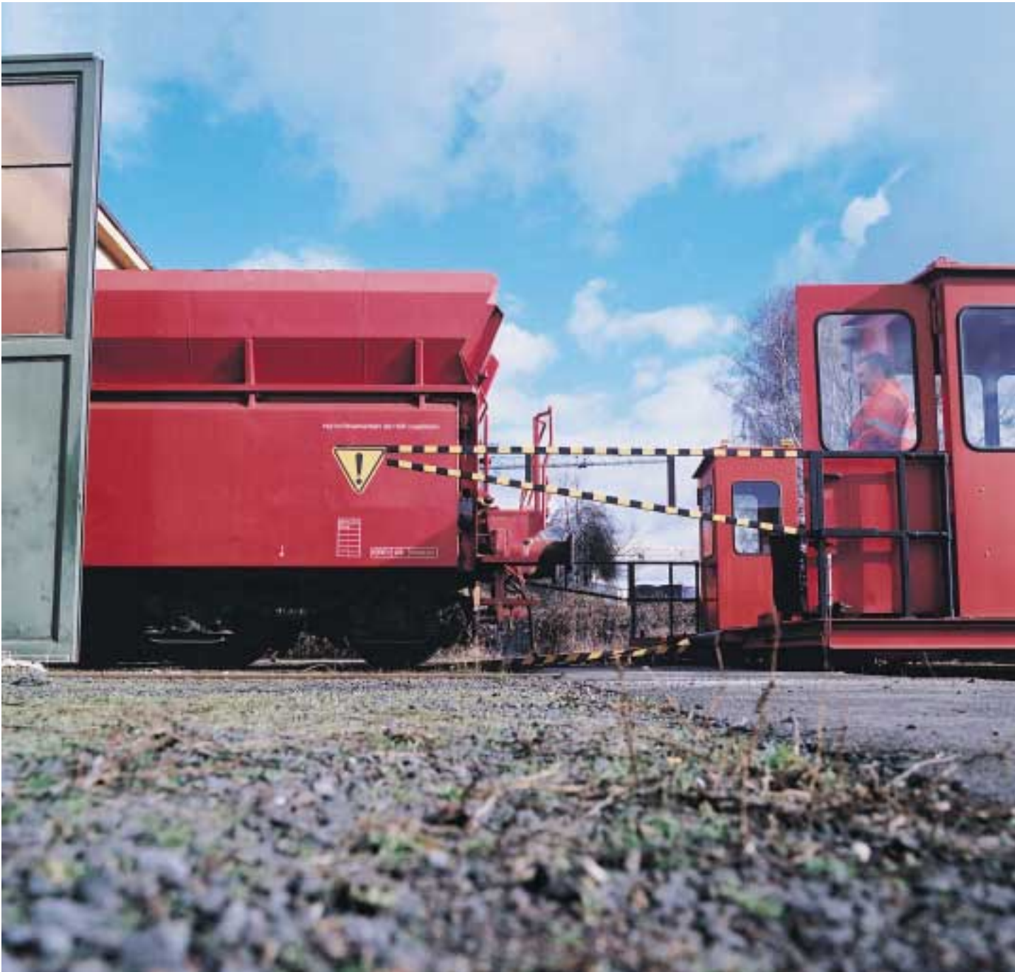
Über eine moderne Schiebebühne wird die Waggonzuführung in die Wagenwerkstatt Brühl-Vochem flexibel gesteuert
